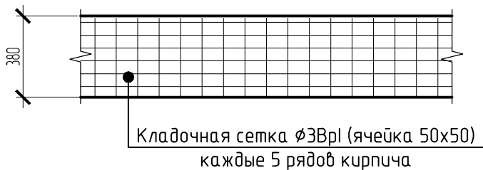
Узел армирования внутренней стены
